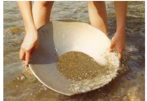
On bateye une quantité connue de graviers, généralement 10 litres. On pèse ensuite les particules d'or ou on les estime à l'œil, obtenant ainsi la teneur au mètre-cube d'alluvions.
